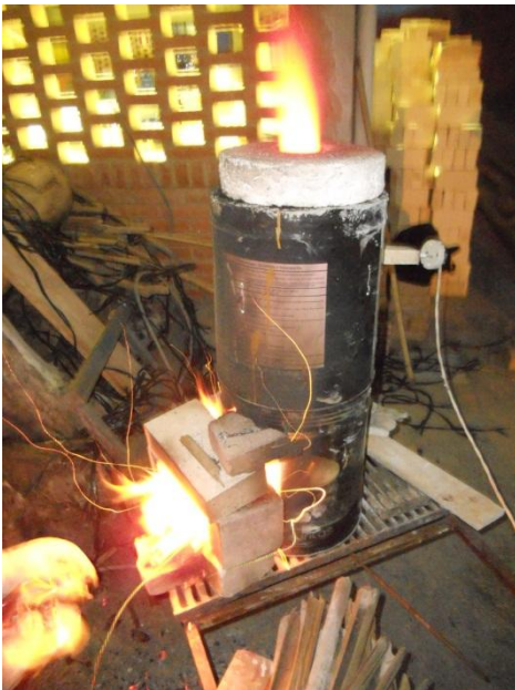
Forno Shichirin nas duas versões testadas e com a respectiva fornalha de tijolos. À esquerda, a primeira, com duas latas empilhadas e à direita a segunda, com apenas uma lata.
