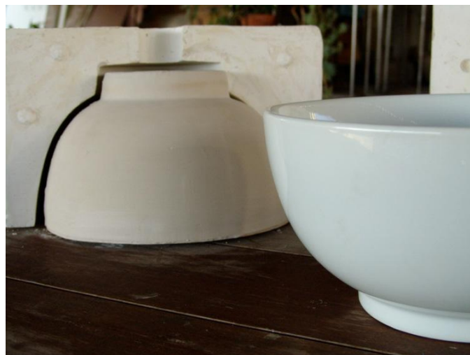
FIGURA 2. Em primeiro plano, tigela de porcelana, e em segundo, cópia da forma ainda crua.
