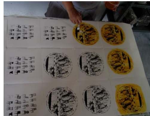
FIGURA 13. Aplicação do colódio sobre a serigrafia.
