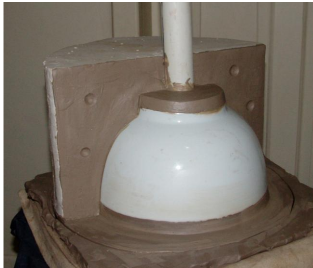
FIGURA 1. Confeção de forma de gesso para reprodução em barbotina, a partir de uma tigela de porcelana industrializada.
