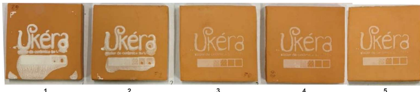
Figura 3. Testes de impressão por serigrafia mistura de CMF123 e condicionador de cabelo – 980°C Fonte: Autora, 2018.
