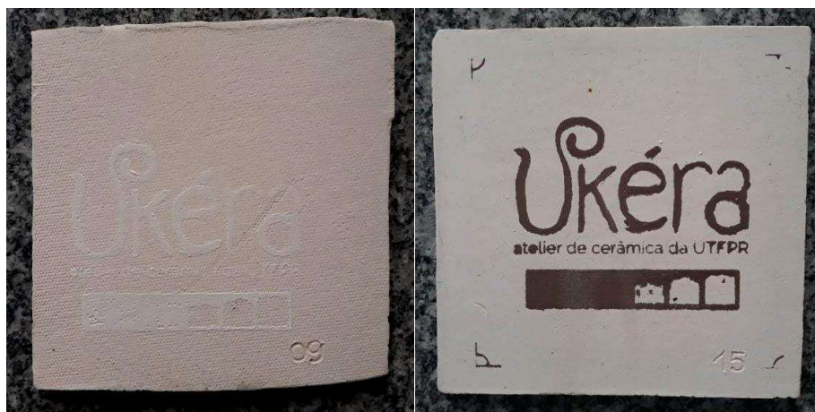
Figura 2. Corpos de prova - serigrafia aplicada com vidrado e óleo de pinho e engobe e água. Fonte: Os autores, 2019
