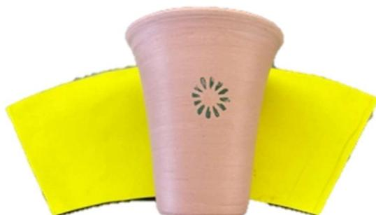
Figura 8 - Transferência indireta com placa emborrachada
