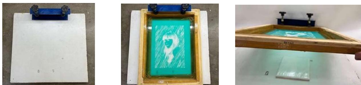
Figura 4 - Tela serigráfica com moldura e mecanismo
