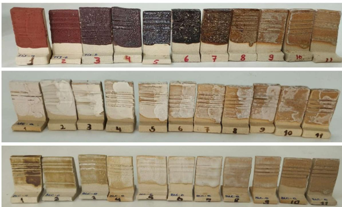
Figura 1: Resultados dos testes lineares com vidro. Ao alto: tijolo, no meio: areia.
