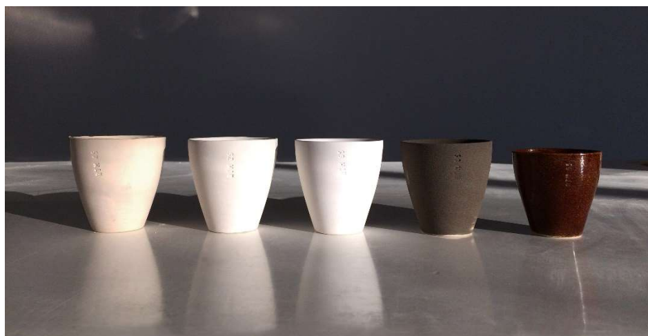
Figura 1. Projeto Smogware . Etapas de produção dos copos de porcelana, vitrificados com fuligem e vidro transparente.
